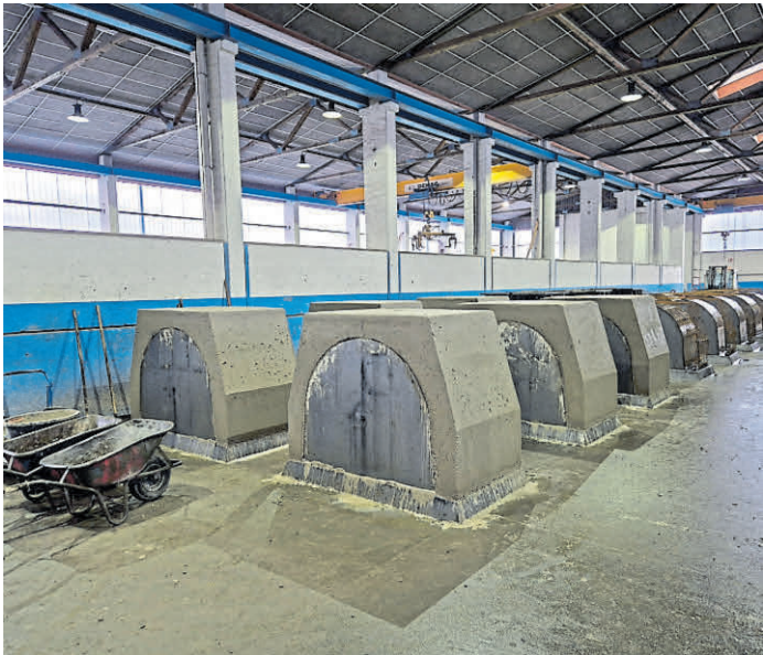
Diese Stützen werden bei Erdkabeln und Gasleitungen verwendet, damit die Kabel durch das Grundwasser nicht nach oben gedrückt werden können.
