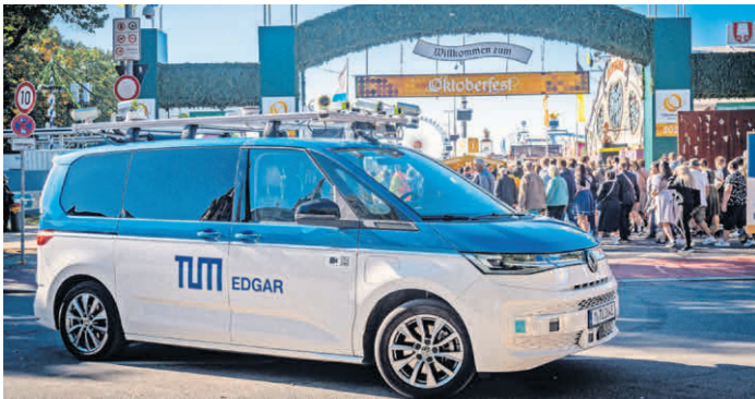
Münchener Forschungsprojekt zur Wiesn: Während der Testfahrten rund ums Oktoberfest saß zur Sicherheit noch ein Fahrer hinter dem Lenkrad, um im Notfall einzugreifen. FOTO: ANDREAS HEDDERGOTT/TUM
