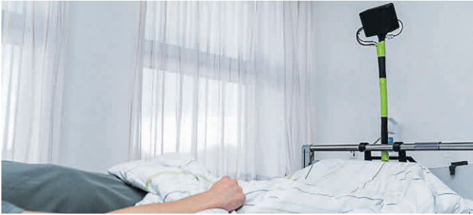
Keine Sensoren am Körper, keine Kabel, volle Bewegungsfreiheit – und trotzdem misst das neu entwickelte Radargerät die Vitalfunktionen der Person. BILD: FRAUNHOFER IDMT/LEONA HOFMANN
