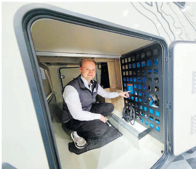
Marcel Klein präsentiert die Batterie des Eura Mobil XTura, die das Wohnmobil zusammen mit Solarzellen für mehrere Tage autark mit Strom versorgt.
