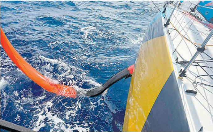
Das beschädigte Backbord-Foil an Boris Herrmanns Yacht „Malizia - Seaexplorer“
