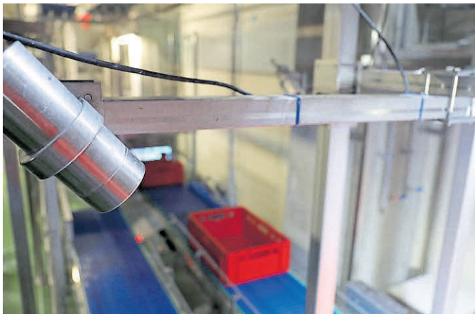
Innovative Lösung: Bei Böselers Goldschmaus in Garrel kontrolliert eine KI die Ergebnisse der Waschstraße.
