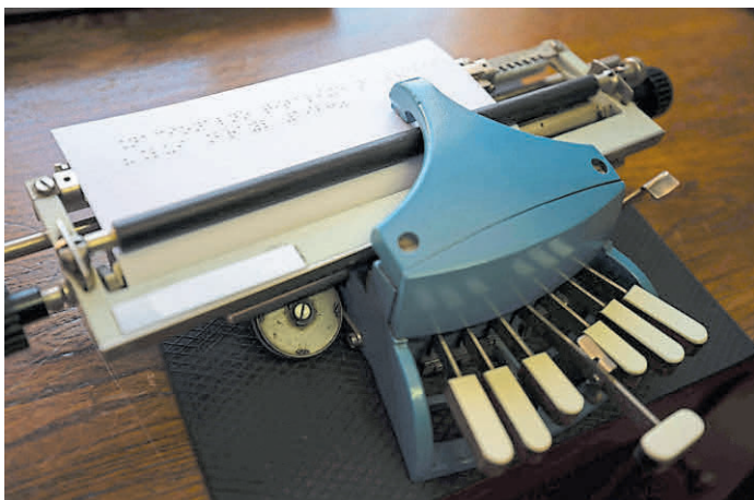
Für das Ausstanzen der Braille-Schrift wurden spezielle Schreibmaschinen hergestellt.
