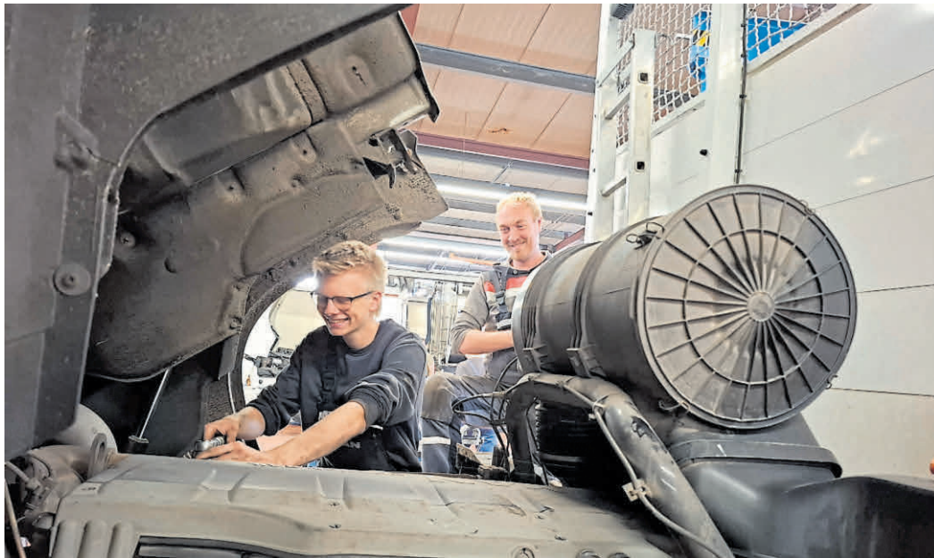
Yorrick beim Kraftstofffilterwechsel bei Wartungsarbeiten am Motor, Geselle Benjamin Kreke beobachtet aus dem Hintergrund.
