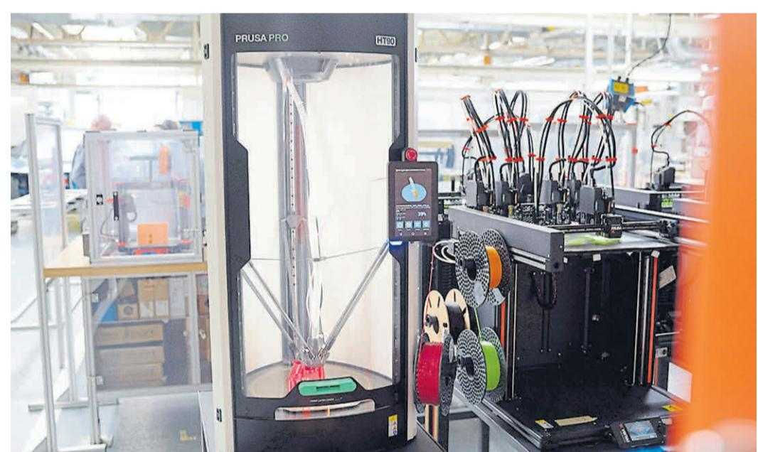
Mit dem Industriedrucker knnen groe Objekte gedruckt werden, ohne dass es zu Verformungen kommt.
