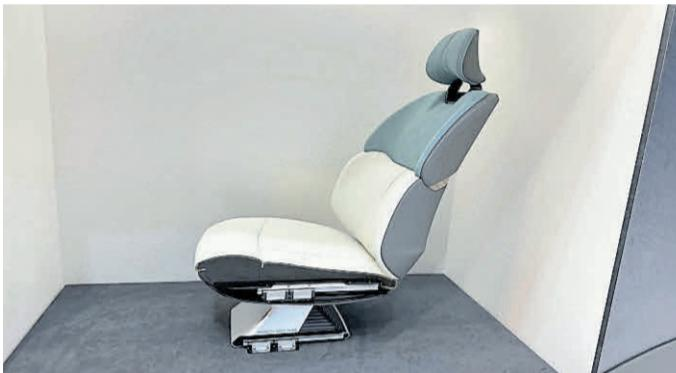
Revolutionär: Versteckt im Sitz ermöglichen mehrere Schienen eine gänzlich unsichtbare elektrische Verstellung.
