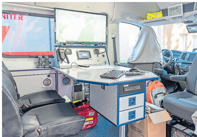
Die Besprechungssecke im ELW-2 mit Bildschirm für Drohnenaufnahmen
