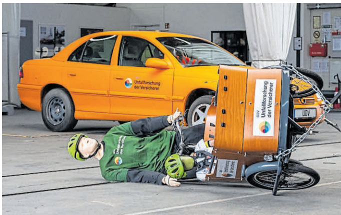
Bei einem Crashtest kippt das Lastenrad um, und die Dummies knallen auf den Asphalt.
