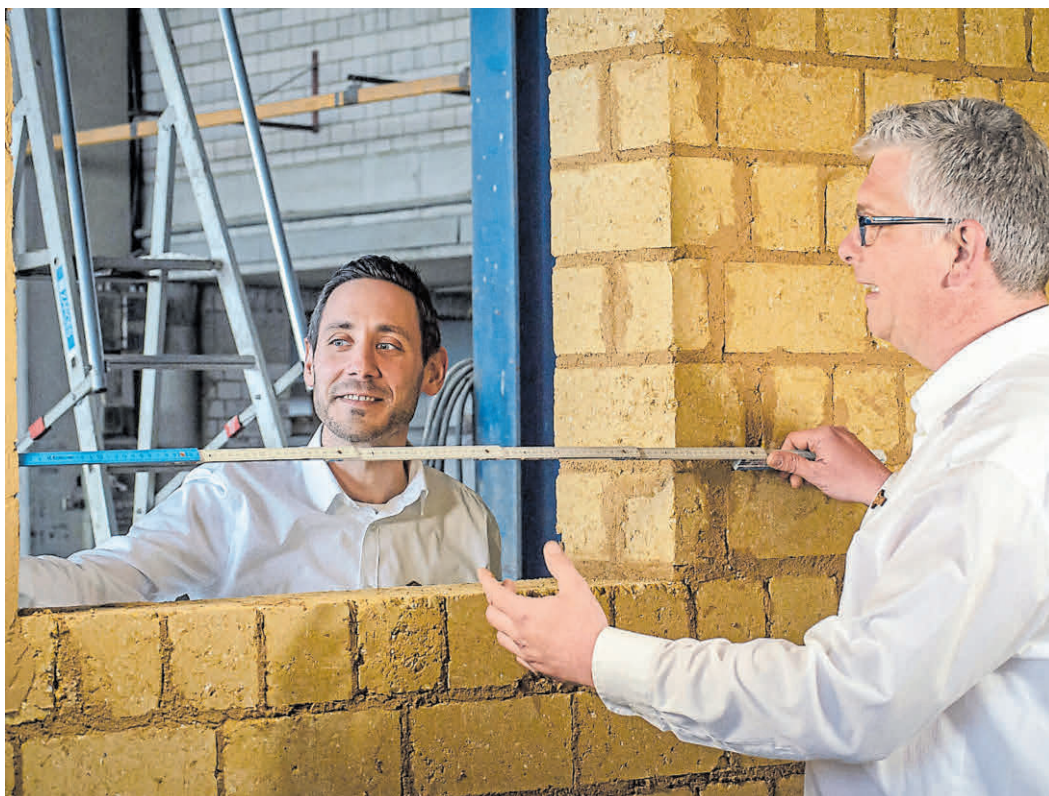
Das Unternehmen Kimm-Baustoffe in Wabern (Hessen) erforscht mit Unterstützung der Deutschen Bundesstiftung Umwelt (DBU) die industrielle Produktion von Lehmsteinen. Der Technische Berater, Stefan Dubielzig (r.), und Vertriebsmitarbeiter Sascha Möller legen bei der Prüfung des Lehm-Mauerwerks selbst Hand an.
