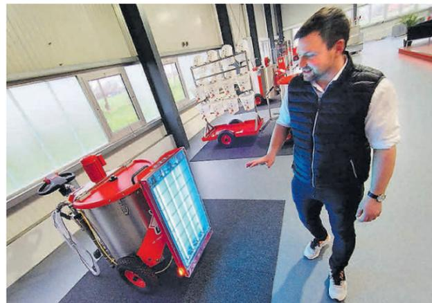
Joshua Hirneiß zeigt eine von Urban Fütterungstechnik entwickelte Variante der UV-C-Desinfektion: In kurzer Zeit werden Keime im Umkreis unschädlich gemacht.
